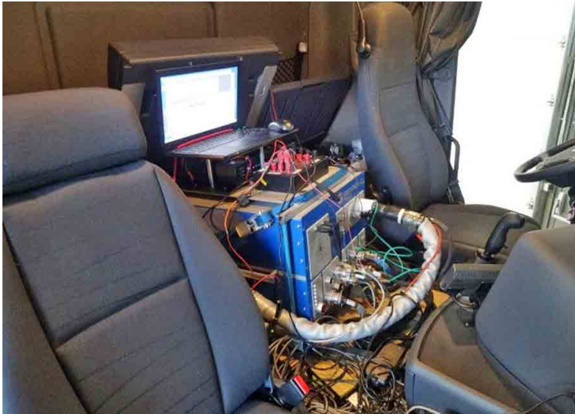
Exemple d'instrumentation avec un équipement de mesure PEMS
